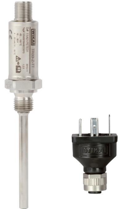
客户在订购时可根据具体应用选择不同的插深、过程连接螺纹和测温元件。TR33 型热电阻温度计包括一个带有固定过程连接的保护管，可直接通过螺纹安装至设备中。电气连接为 M12 x 1 圆型接头。可通过电气转换插头转换成符合 DIN EN 175301-803 标准的方形接头（工业产权注册号 001370985）。
